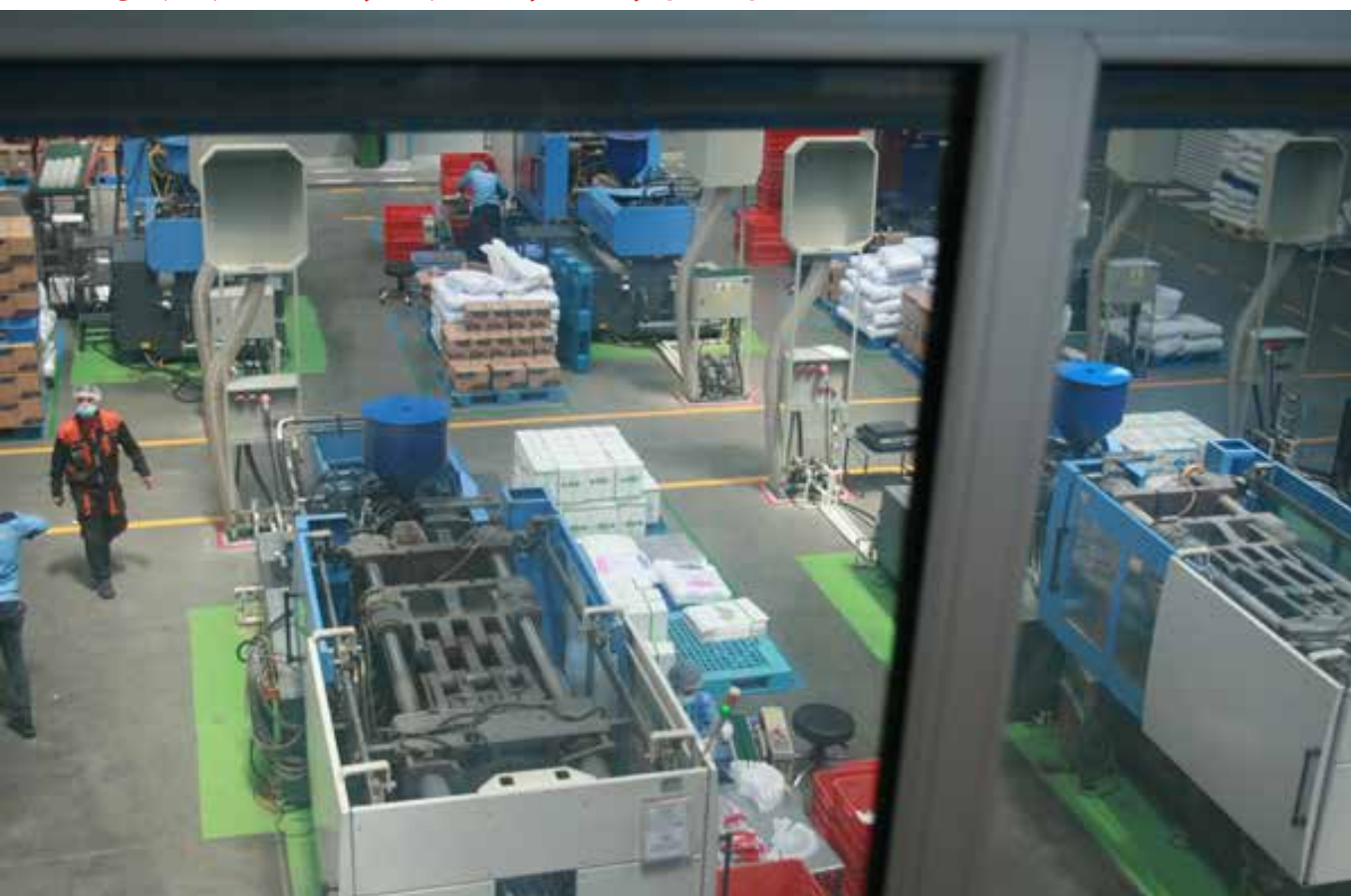
شکل ۲. محل تولید محصول در شرکت توسط قالب‌گیری تزریقی
