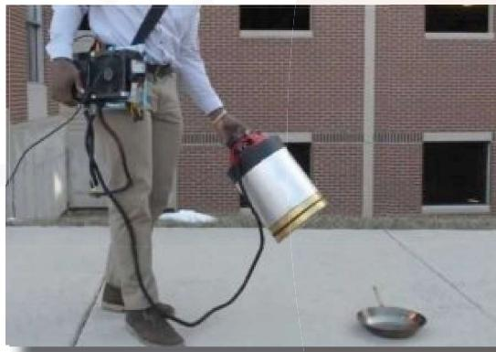
شکل ۳- اطفاء حریق با امواج صوتی [۸]
